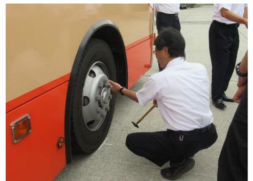
車両点検は、ブレーキ・タイヤ・灯火類・燃料など運行前後の確認が義務付けられています。毎日の点検の積み重ねがわずかな変化への気づき、すなわち早期の異常発見につながります。
